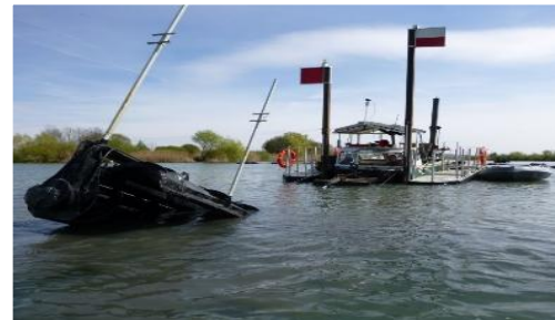
Foto WWA AN Schneidkopf (herkömmliche Technik)
