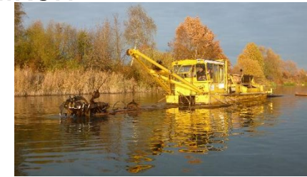
Foto WWA AN Schneidkopf (herkömmliche Technik)
